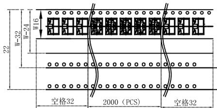
3. 载带材料规格: PS 白色料抗静电, 厚度 0.30mm.
